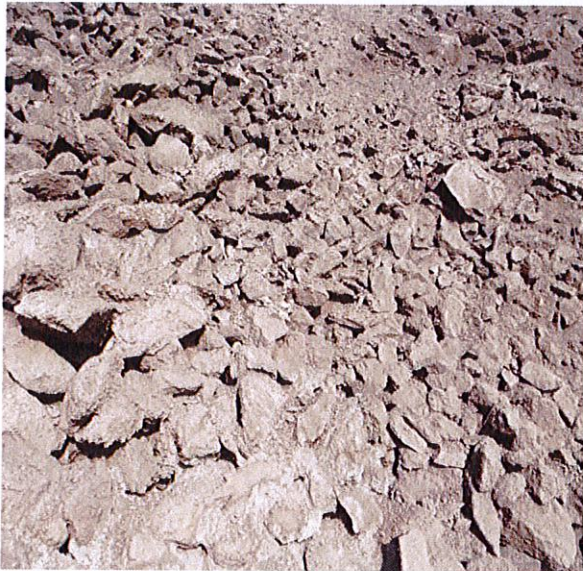
照片 43 喷射水泥砂浆固化废渣
